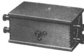
Abb. 187. Thermoelement nach Schering (H. &amp; B.)
