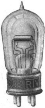
Abb. 158. Elektronenröhre S. & H. Typ RE86, J_a = 0,22\text{A} , P_a = 50-100\text{V} , S = 0,4\text{m A/V} , R_i = 25000\ \Omega .
