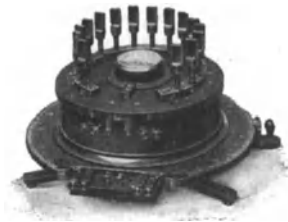
Abb. 102. Meßbrücke von Siemens & Halske für größere Selbstinduktionen (vgl. Anhang).
