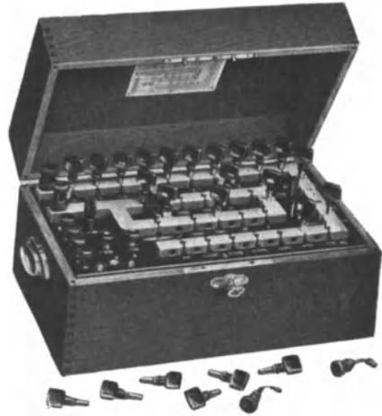
Abb. 229. Serienstöpselbrücke von Hartmann & Braun.
