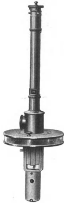
Abb. 116b. Auswechselbarer Einsatz zum ballistischen Galvanometer.
