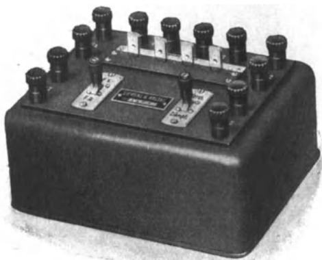
Abb. 289. Verstärkungsmesser von Siemens & Halske.
