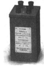
Abb. 185. Thermoelement S. &amp; H. zum Galvanometer Abb. 30.
