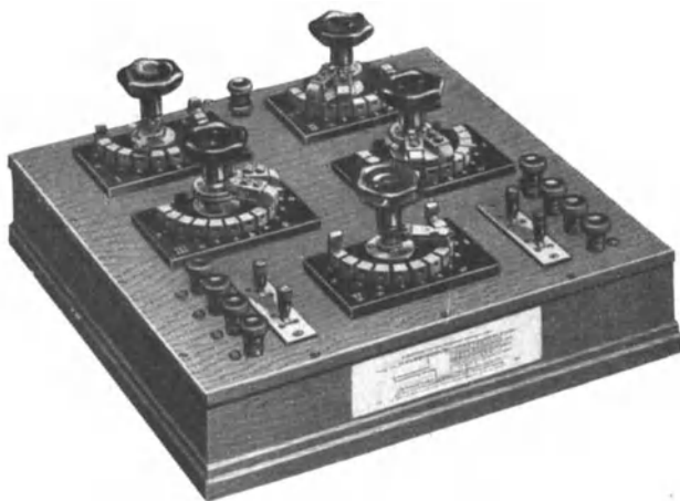
Abb. 239. Kompensationsapparat von Hartmann & Braun mit Feußnerscher Schaltung.
