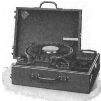
Abb. 88. Fehlerortbrücke mit Schleifdraht (S. & H.).
