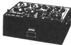
Abb. 226b. Die Thomson-Doppelbrücke S. & H.
