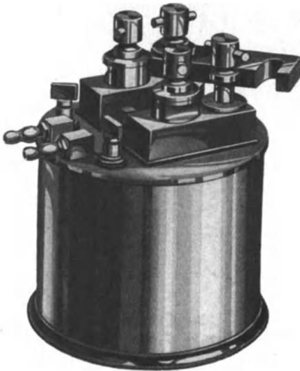
Abb. 222. Normalwiderstand von Hartmann & Braun für hohe Stromstärken.
