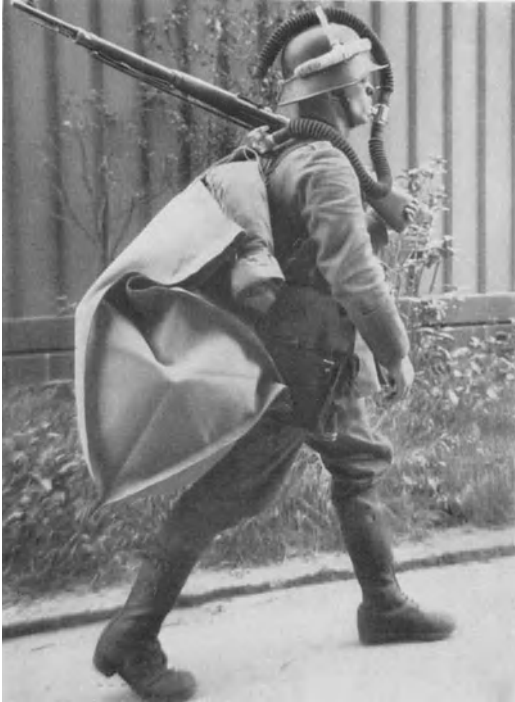
Abb. 1. Messung des Energieverbrauchs beim Marsch nach der DOUGLAS-Sackmethode. (Mit Genehmigung des Kaiser Wilhelm-Instituts für Arbeitsphysiologie.)
