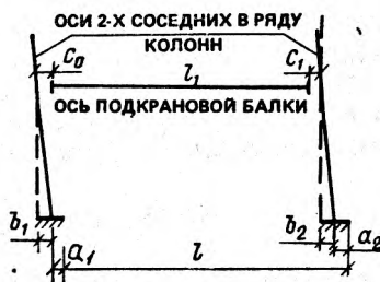
Рис. XII.4. Схема расположения подкрановой балки на консолях колонны (в виде направленных отрезков)
