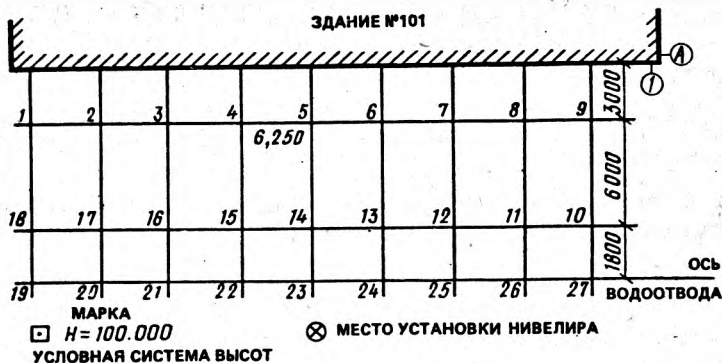
Рис. X.5. Схема нивелирования полотна (цифрами обозначена последовательность точек нивелирования)
