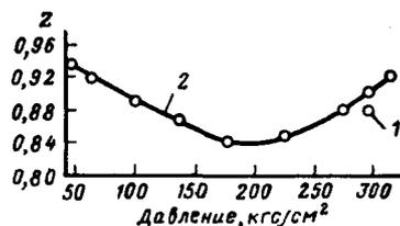
Рис. 77. Изменение выхода бензиновых фракций в процессе разработки газоконденсатного месторождения
