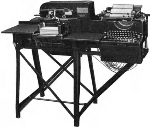
Abb. 29. Powers Lochmaschine mit gekoppelter Schreibmaschine.
