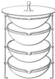
Abb. 29. Einsatz für die Erhitzung der Substanz mit Glycerin-Schwefelsäure im Dampftopf zur Bestimmung der Rohfaser.
