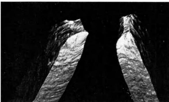
Abb. 50 a. Durch Zugbeanspruchung gebrochener Stab aus weichem Blei mit Fließfiguren. (Ansicht der Bruchflächen.)
