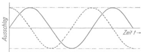
Abb. 317 und 318. Graphische Darstellung einfacher cos- und sin-Schwingungen.
