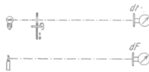
Abb. 547. Glühlampe und Kerze erzeugen aus gleichem Abstand die gleiche Bestrahlungsstärke, nachdem man die eine Strahlungsstärke mit einem rotierenden Sektor auf 1/p herabgesetzt hat.
