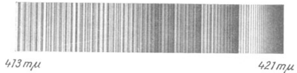
Abb. 487. Ausschnitt aus dem Emissionsspektrum des N_2 , also eines homöopolaren Moleküles.
