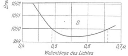
Abb. 95 und 96. Zum Farbenfehler dünner Linsen und seiner Behebung.
