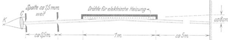
Abb. 12. Spiegelung (Totalreflexion) eines Parallellichtbündels an der Grenze zwischen heißer und kalter Luft. Bündel am rechten Ende etwa 2 cm dick. K = Krater einer Bogenlampe.
