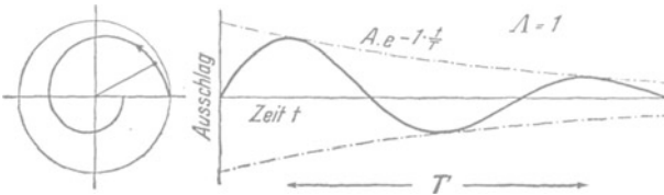
Abb. 331. Zwei graphische Darstellungen einer gedämpften Sinusschwingung.
