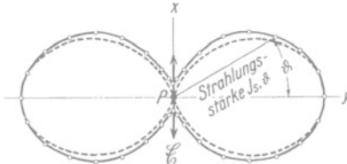
Abb. 337 a. Zur RAYLEIGHSCHEM Streuung von polarisiertem Licht an kugelförmigen isolierenden Teilchen. Das primäre Lichtbündel steht in P senkrecht zur Papierebene und \mathcal{C} markiert seine Schwingungsebene. Fahrstrahl = Strahlungsstärke (= Ausschlag \alpha des Strahlungsmessers M in Abb. 336). Die Figur ist rotationssymmetrisch um den Doppelpfeil \mathcal{C} als Achse zu ergänzen.
