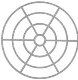
Abb. 91. Ein auf Mattglas gezeichnetes Rad mit mehreren Felgen, Speichen und Felgen klar, übrige Fläche undurchlässig, eignet sich vorzüglich zur Prüfung von Linsen auf Astigmatismus und Bildfeldwölbung. Auch in diesem Fall setzt man die optische Bank auf einen Wagen. Die Bildfeldwölbung einfacher Linsen wird dann sehr eindrucksvoll. Man muß den Wagen oft um mehrere Meter verschieben, um Kreise oder Radien entweder nahe der Bildmitte oder nahe dem Bildrande scharf einzustellen. Etwa \frac{1}{5} nat. Größe.
