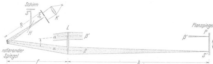
Abb. 240. Zur Messung der Lichtgeschwindigkeit nach dem Verfahren von FOUCAULT (1850), vereinfacht durch A. A. MICHELSON 1878. Der rotierende Spiegel ist Eintrittspupille, der Strahlengang rechts von L telezentrisch. Zahlenbeispiel: R = 5,2 m; f = 10,5 m; b = 32 m; Durchmesser von L und P je 30 cm, Durchmesser des rotierenden doppel-seitigen Spiegels 5 cm. N bis 300 sek -1 , d. h. Drehzahl des Spiegels N/2 je Sek.; Verschiebung s des Spaltbildes bis zu 4 mm.
