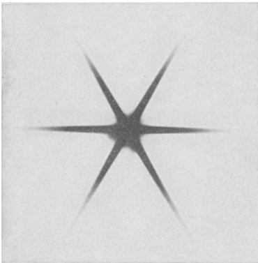
Abb. 59. Der Bildpunkt einer Linse bei Begrenzung durch eine dreieckige Öffnung von 1 cm Kantenlänge. In 5 m Abstand mit Rotfilterlicht, in natürlicher Größe photographiert (15 Sek. bel.).
