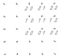
Abb. 220. Beugungsfigur der beiden einander komplementären Punktgitter der Abb. 218 und 219.
