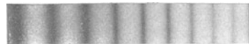
Abb. 272. Interferenzstreifen in kontinuierlichem Spektrum, hergestellt mit einer parallel zur optischen Achse geschnittenen Quarzplatte von etwa 1,1 mm Dicke.
