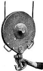
Fig. 310. Sicherheitshaken nach Bleichert.
