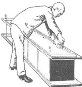
Abb. 18. Festziehen aller hinteren Schrauben und vorderen Eckschrauben.
