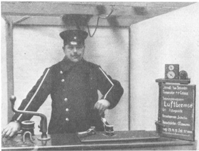
Abb. 54. Einfache photographische Aufnahme von Bedienungs- und Arbeitsstellungen. (Das Bild zeigt die Bedienungsstellung des Führers während der Fahrt bei der Luftdruckbremse.)
