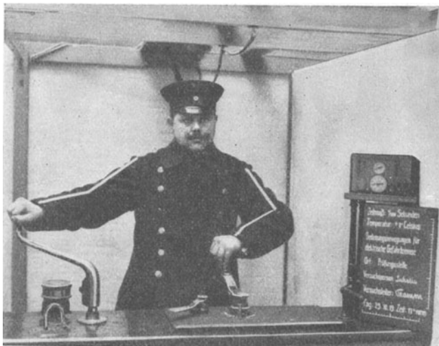
Abb. 12. Ein sinnfälliges Bild für die Unterweisung und Anlernung von Straßenbahnführern. (Das Bild zeigt die Bedienungsstellung des Führers während der Fahrt bei der elektrischen Bremse.)
