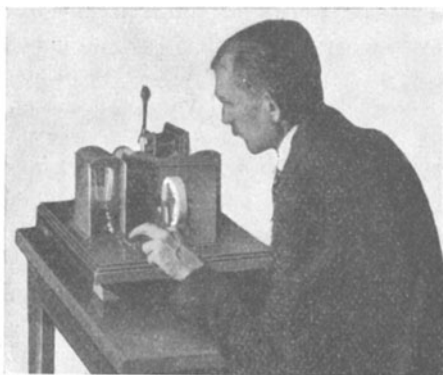
Abb. 88. Apparat zur Messung der Ermüdung der Augen. Durch eine beleuchtete Lampe hindurch müssen bestimmte Zeichen solange wahrgenommen und in bestimmter Weise beantwortet werden, bis das Auge ermüdet.
