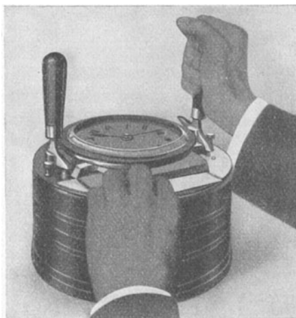
Abb. 29. Additionsstempeluhr. Ein praktisches Hilfsmittel zur Messung größerer Arbeitszeiten.
