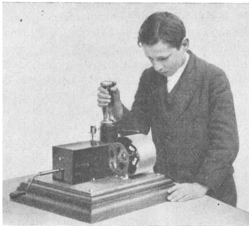
Abb. 81. Apparat zur Untersuchung der Ermüdung der Hand. Der Prüfling hat die Handgriffe, die durch Federn gespannt sind, solange zusammenzudrücken, bis die Hand ermüdet ist.
