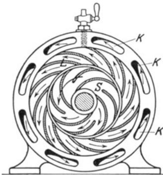
Abb. 138. Querschnitt durch eine Kreiselpumpe. S = schnell rotierendes Schleuderrad; L = feststehendes Leitrad; K = Abflußkanäle nach der Druckleitung.
