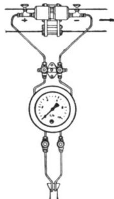
Abb. 165. Schematische Anordnung der Meßanlage in waagrechtlicher Dampfleitung.
