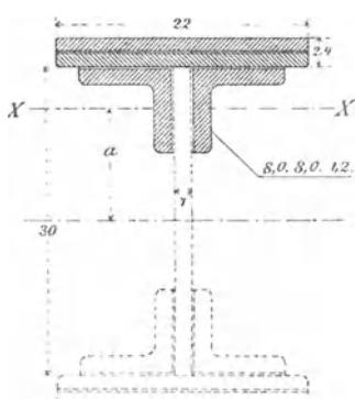
13. Für die obere Gurtung einer kleinen Fachwerksbrücke ist nebenstehendes Profil erforderlich, von welchem zur Berechnung der Knickfestigkeit das Trägheitsmoment bezogen auf die Schwerachse  $X-X$  ohne Nietabzug zu ermitteln ist.
