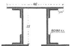
Freier Ueberstand der oberen Gurtplatte, wegen der Befestigung der Buckelplatten 5 cm. Wie gross wird das  $W$  dieses Profils bei 35 cm Höhe; 4 Winkeln  $9,0 \cdot 9,0 \cdot 1,1$  und einer Gurtplatte von  $46 \cdot 1$  cm.
