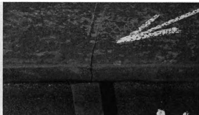
Abb. 19. Versuch 18, Gurte aus halben Peiner Trägern. Riß von der Gurtplattenkante ausgehend,  $1,270 \cdot 10^6$  Lastwechsel,  $\sigma_o^R = 2050 \text{ kg/cm}^2$ ,  $\sigma_u^R = 310 \text{ kg/cm}^2$ .
