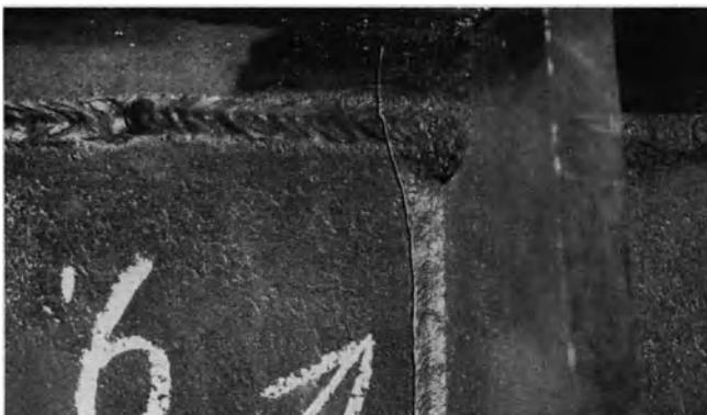
Abb. 10. Versuch 9, Dörnen-Wulstprofil. Riß von der zu dicht an dem Zuggurt endenden Aussteifungskehlnaht ausgehend,  $0,992 \cdot 10^6$  Lastwechsel.
