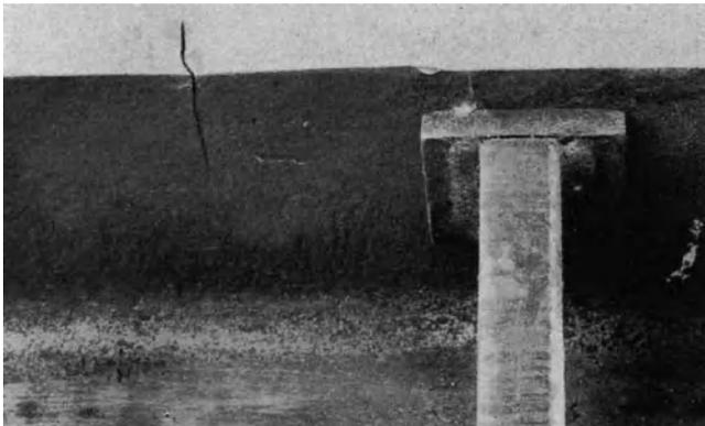
Abb. 9. Versuch 4, Krupp-St.-Profil. Riß von der Gurtplattenkante ausgehend,  $0,586 \cdot 10^6$  Lastwechsel,  $\sigma_o^R = 2280 \text{ kg/cm}^2$ ,  $\sigma_u^R = 200 \text{ kg/cm}^2$  im Bruchquerschnitt.
