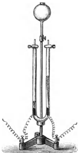
Abb. 8. Vorrichtung zur elektrolytischen Zerlegung des Wassers.
