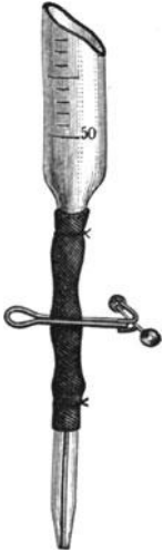
Abb. 92. Verschluss einer Bürette mittels eines Quetschhahnes.
