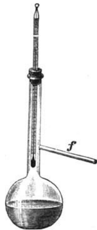
Abb. 63. Fraktionskölbchen für die Siedepunktbestimmung.
