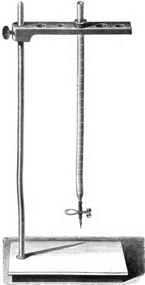
Abb. 94. Quetschhahnbürette an einem hölzernen Stativ.
