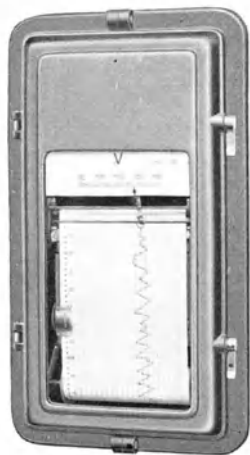
Abb. 99. Tintenschreiber von S. & H. für Schalttafelbau.
