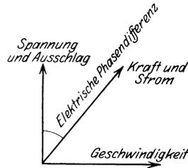
Abb. 115. Phasenbeziehungen beim Pendelgleichrichter in der Stellung X der Abb. 114.
