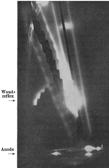
Abb. 26. Glimmlichtverstärkung in einer V-förmigen Kathode aus Eisen in Wasserstoff von 1 mm Druck. *a a* Kathodenschenkel, *b b* Glimmlicht. Der linke Kathodenschenkel ist treppenförmig.
