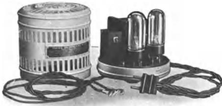
Abb. 167. Innerer Aufbau des Philipsgleichrichters.
