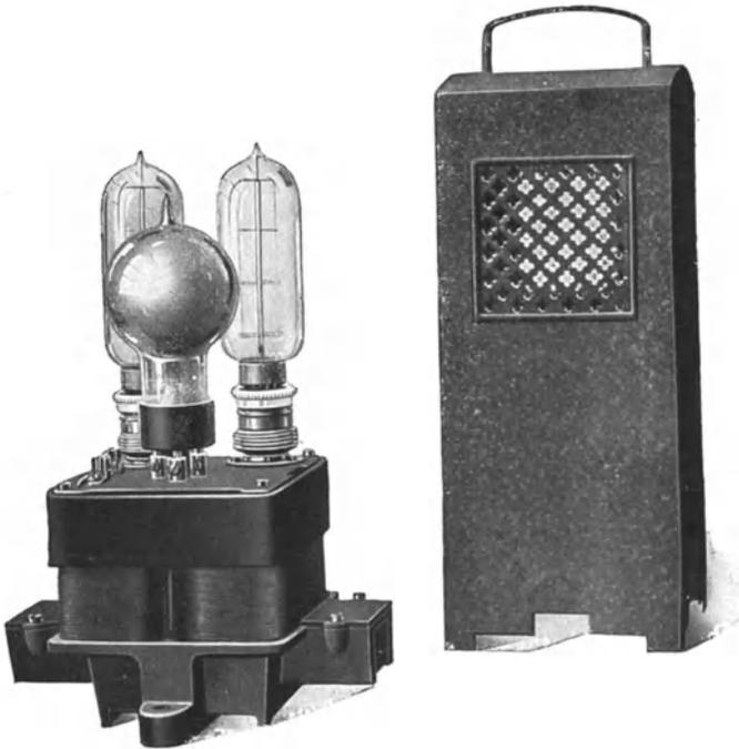
Abb. 163. Afa-Gleichrichter für maximal 35 V 1 bis 6 Amp. zur Ladung von 1 bis 12 Bleiakкумуляtorenzellen.
