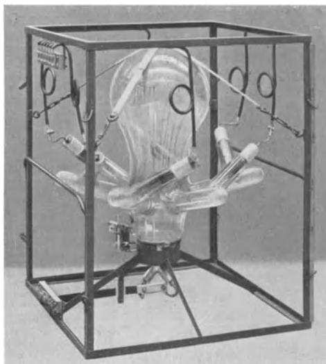
Abb. 210. Glasgleichrichter der 350 Amp.-Type der SSW mit Spritzzündung im auswechselbaren Rahmengestell.
