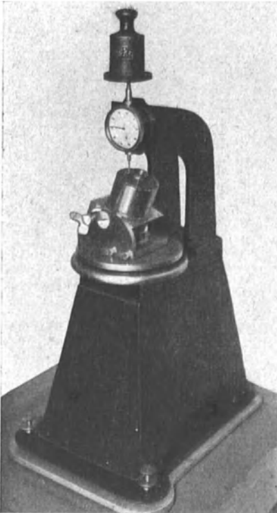
Abb. 27. Gerät zur Bestimmung der Weichheitszahl von Gummi und von Hülsenfedern (Bauart BMW Spandau)
