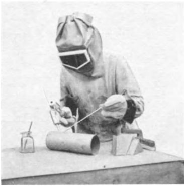
Abb. 4. Schweißhaube mit aufklappbarem Schutzglas.
