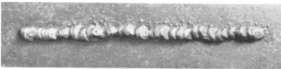
Abb. 6. Schweißraupe, mit zu niedriger Stromstärke hergestellt.
