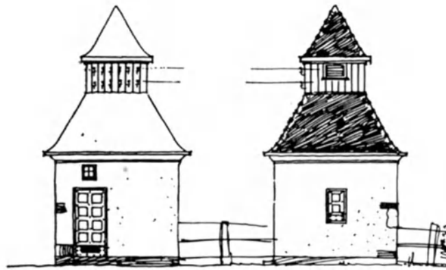
Abb. 349. Elbtalzentrale. Normale Kabelstation mit Niederspannungsausführung nach allen Seiten, errichtet für freie Plätze, daher Dach nach allen Seiten abgewalmt. Architekt: W. Issel, Berlin.
