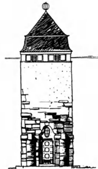
Abb. 348. Elbtalzentrale. Hochspannungsturm für den Augustusberg Gottleuba. Aus dem Ort entnommener Sandstein, für hervorragenden Aussichtspunkt erbaut. Architekt: W. Issel, Berlin.
