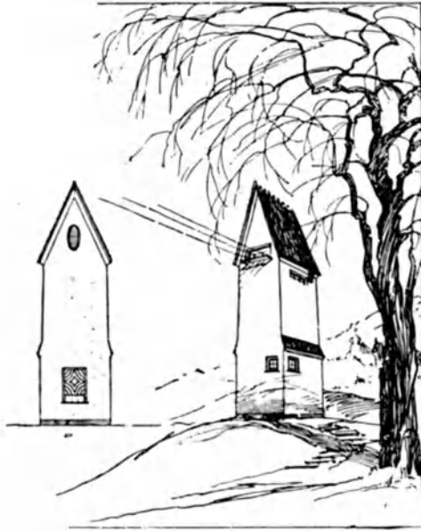
Abb. 345. Elbtalzentrale. Normale Station für Hochspannungseinführung und Niederspannungsabgang; Einführungsöffnung im Giebel, daher Höhenersparnis. Architekt: W. Issel, Berlin.
