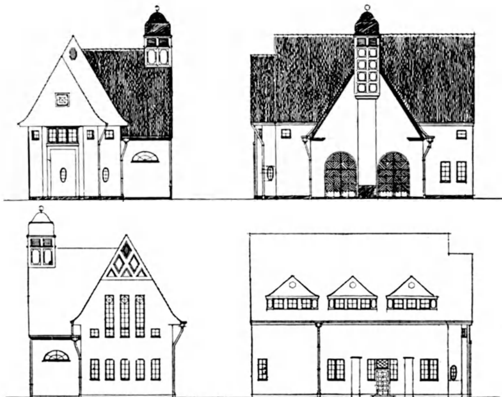
Abb. 313. U.C. Gotha. Unterstation Eisenach für 2 Transformatoren. Station ist in einer Vorstadt errichtet und deren Villencharakter angepaßt. Architekt: W. Issel, A.E.G., Berlin.
