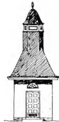
Abb. 356. U.C. Gotha. Station für Kabeleinführung und Niederspannungsausführung nach allen Seiten für Suhl, durch Wahl der Form und Beschieferung dem Stadtbilde angepaßt. Architekt: W. Issel, Berlin.
