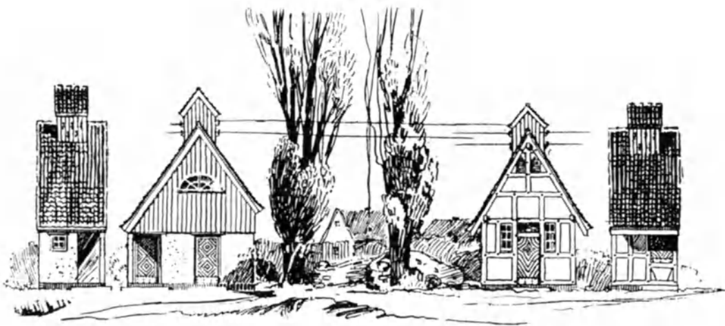
Abb. 351. Projekt Güstrow. 2 Kabelstationen mit Niederspannungsausführung nach 2 Seiten. Der Bauart kleiner Landstädte angepaßt durch Verwendung von Fachwerk und Schalung mit hellen Putzflächen. Architekt: W. Issel, Berlin.
