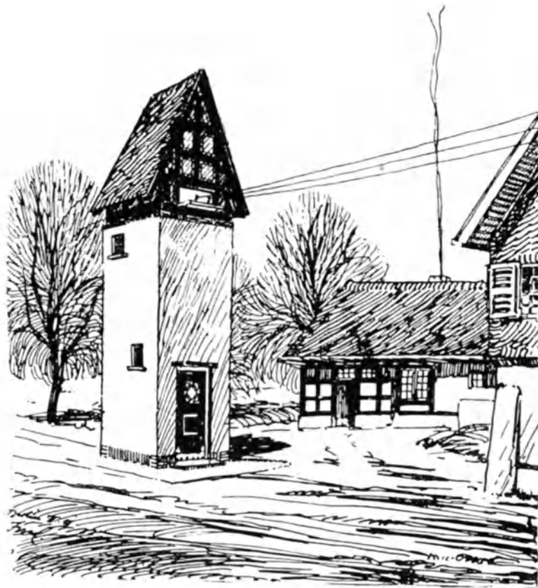
Abb. 352. E.W. Obererzgebirg. Normale Station mit einer Hochspannungseinführung, der Umgebung angepaßt. Architekt: W. Issel, Berlin.
