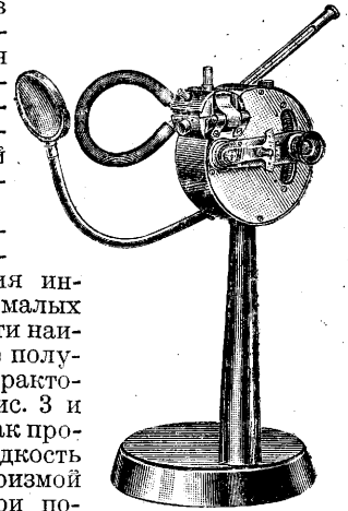
Рис. 7. Рефрактометр для сахара и жидких масел.
