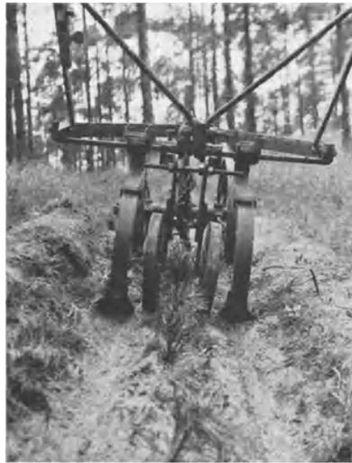
Abb. 245. Maschinenmäßiges Behacken einer Kiefernplantation mit dem NEUMANN-HILFschen Igel mit 2 Hackscharen (rechts und links) und 2 Schutzscheiben (in der Mitte). (Aufn. des Iffa, Eberswalde.)
