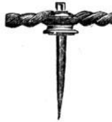
Abb. 393. Klemmrolle mit Stahldübel.
