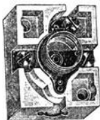
Abb. 424 u. 425. Normalelement für Edison-Sicherungen (AEG).
