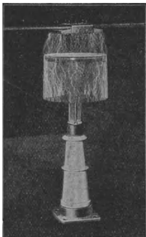
Abb. 558. Glimmentladung als Überspannungsschutz (Dr. Paul Meyer A. G.).
