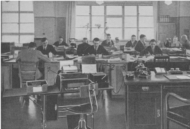
Abb. 206. Fernschreibmaschine mit Eintongerät. 1. Fernschreibmaschine. 2. Eintongerät. 3. Umschalter.
