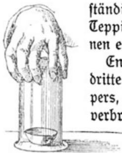
Abb. 77. Löschen einer Flamme durch Abschließen der Luft.
