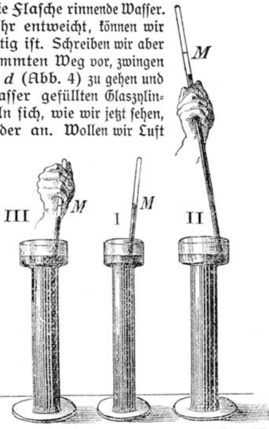
Abb. 5. Ein und dieselbe Gasmenge nimmt unter verschiedenen (Druck- und Temperatur-) Verhältnissen einen wechselnden Raum ein.
