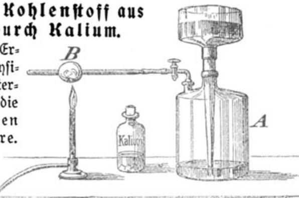
Abb. 48. Zerlegung der Kohlensäure durch Kalium.
