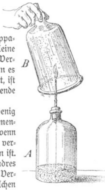
Abb. 38. Bei der Verbrennung von Wasserstoff entsteht Wasser.
