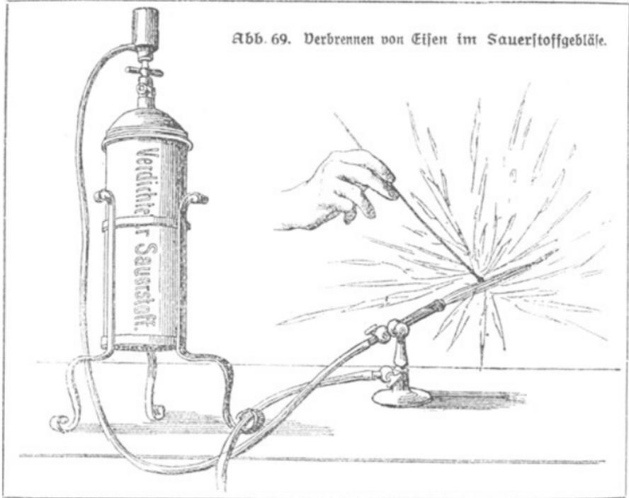
einer kleinen Kugel, die nicht herabfällt, weil das geschmolzene Metall von der gegenströmenden Flamme in Form kleinster Teilchen weggeschleudert wird. Nach allen Seiten sprühen helleuchtende Sternchen und führen uns eine der glänzendsten Erscheinung der Experimentalchemie vor Augen (Abb. 69).
