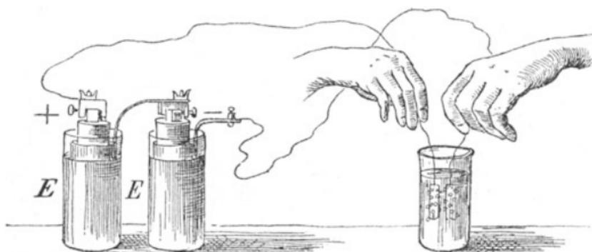
Abb. 31. Zerlegung des Wassers durch den elektrischen Strom.
