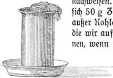
Abb. 91 Abcheidung von Kohlenstoff aus einer Zuckertlösung.
