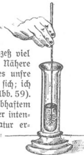
Abb. 59. In verflüssigter Luft verbrennt ein Holzspan mit hellleuchtendem Glanze.
