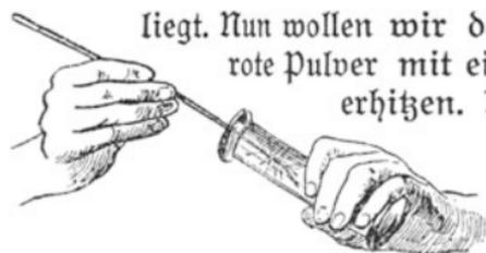
Abb. 19. In dem durch Erhitzen von Quecksilberoxyd gewonnenen Gase entzündet sich ein glimmender Span und verbrennt mit glänzendem Licht.
