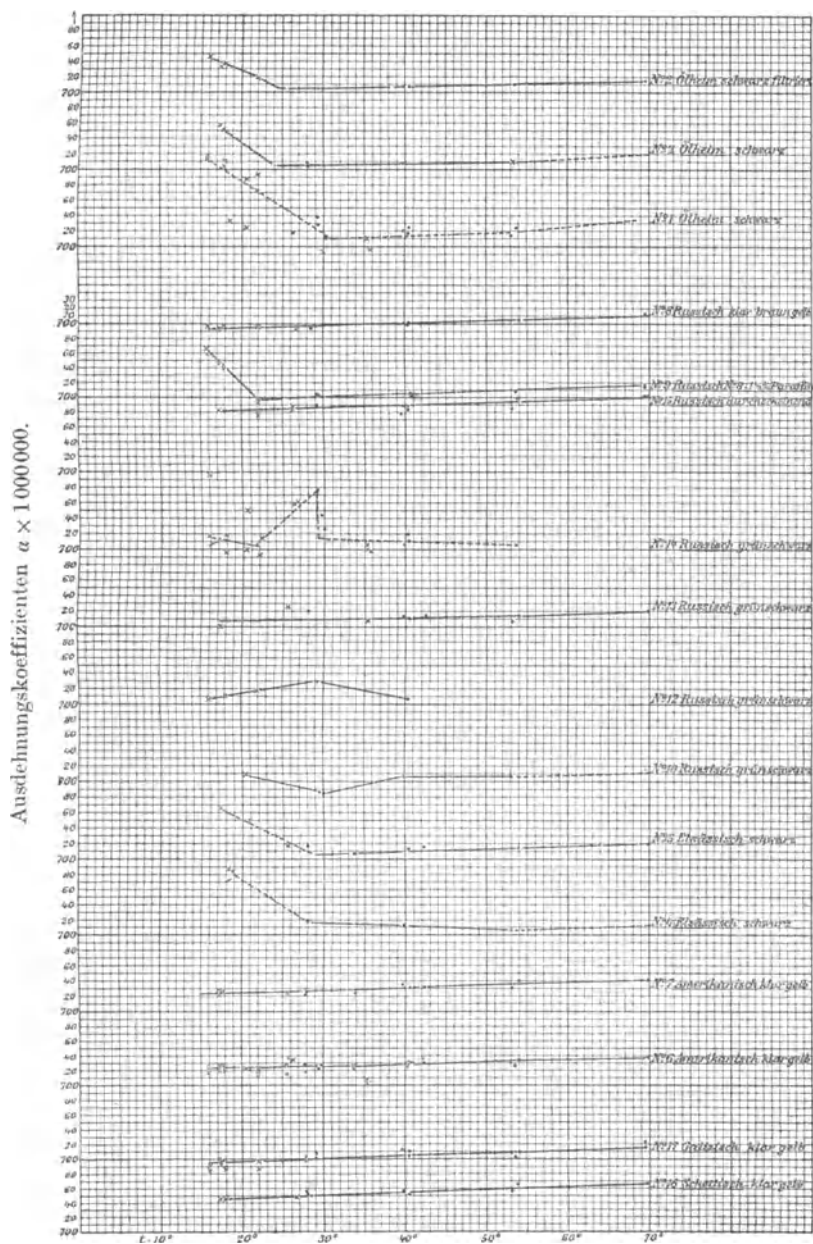
Fig. 92. Veränderungen des Ausdehnungskoeffizienten von Mineralölen mit der Temperatur.
