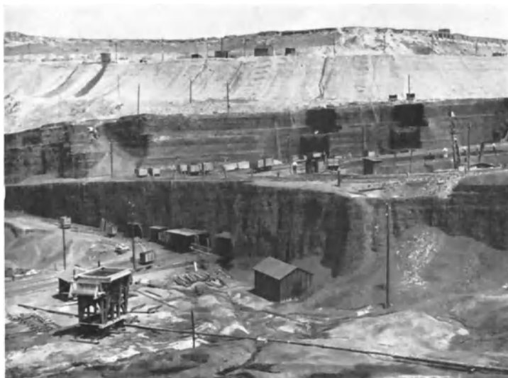
Abb. 57. Braunkohlen-Tagbau im Sudetenland (Brüx). Wegen der festen Beschaffenheit dieser Braunkohlen sind die maschinellen Abbaumethoden (vgl. Abb. 58) wenig anwendbar. Der Betrieb ähnelt mehr dem von Steinbrüchen. Aufn. K. A. Jurasky.
