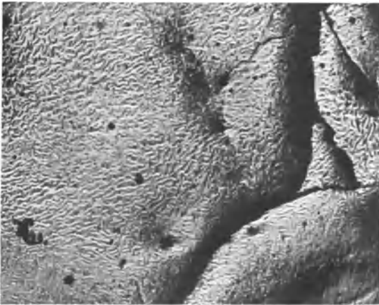
Abb. 42. Wellenstruktur von Steinkohlen- Vitrit , bei Anwendung von Öl-Immersion hervortretend (vgl. Abb. 41). Reliefschliff, auffallendes Licht. Vergr. 72. Aufn. E. Stach.
