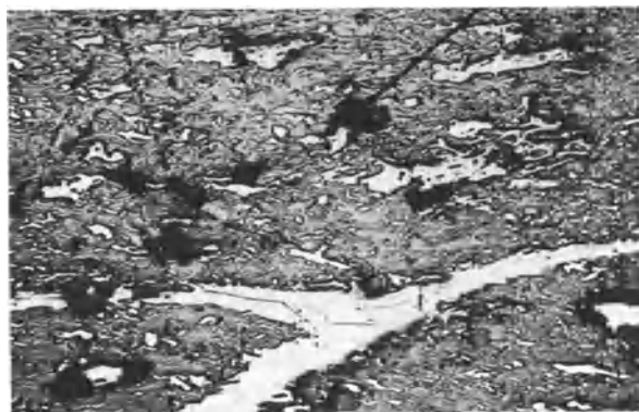
Abb. 46. Durit (Kannelkohle) mit Vitrit ader. Niederschlesien. Reliefschliff, auffallendes Licht. Vergr. 160. Aufn. K. A. Jurasky.
